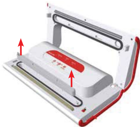
Фигура 6: Когато течността попадне във вакуумния канал, повдигнете тавата за капан за течности директно нагоре, излейте течността, измийте тавата и я подсушете добре.
